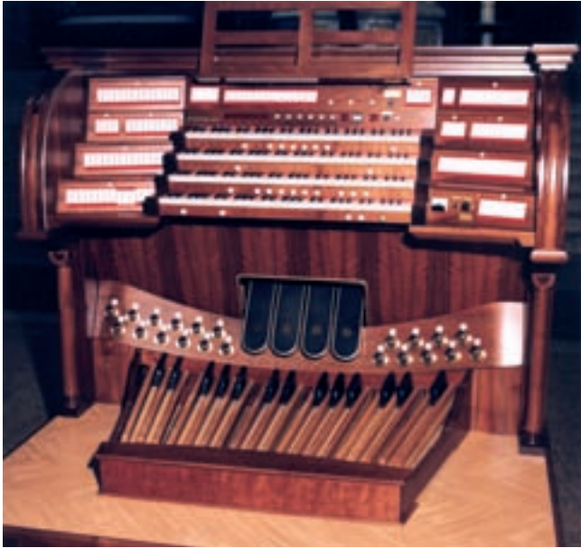
La nuova consolle con le 4 tastiere e le placchette dei registri ai lati; in basso la pedaliera, le 4 staffe centrali e i pistoni a pedale ai due lati.
